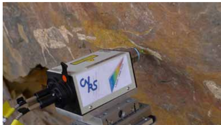
Fig. 4. Spectroscopie Raman portable utilisée pour identifier des pigments sur un site de peinture rupestre. Lieu : site de Maloti-Drakensberg, Afrique du Sud, inscrit au Patrimoine mondial. (Photo © L. Ronat.)
