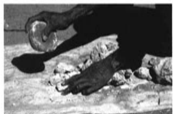
Figure IV-19: Concassage sur tôle (VY.01, Togo).
