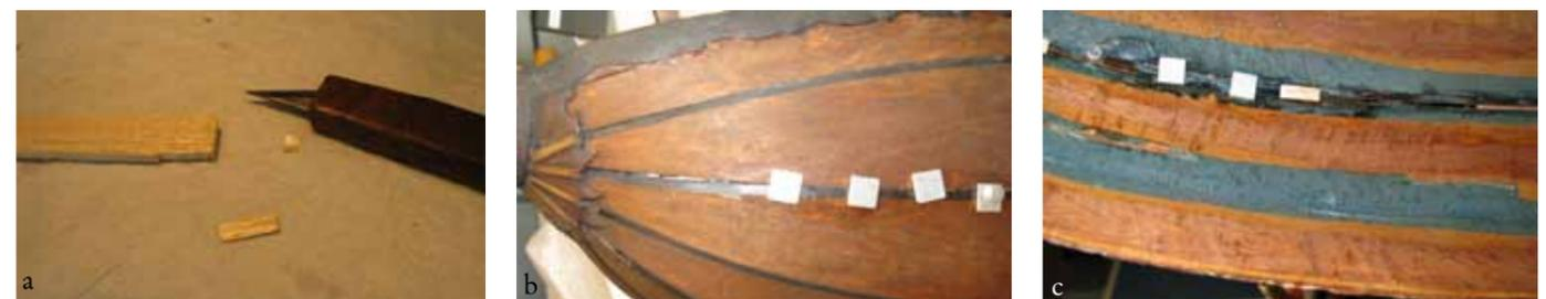
Fig. 15. a. Taquets de renforts en épicea : découpe ; b. refixage du filet grâce à des aimants ; c. vue de l'extérieur ; d. vue de l'intérieur. (© Musée de la Musique. Photos : Anne Houssay.)
