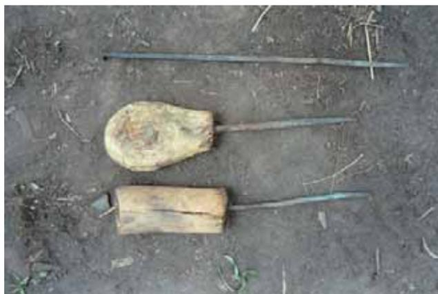
Ces poinçons s'utilisent à chaud pour percer les manches de bois dans lesquels viendront s'insérer les lames de houe, de hache ou de herminette.
