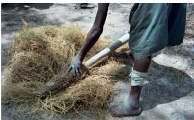
Moule enduit de solution argileuse.
