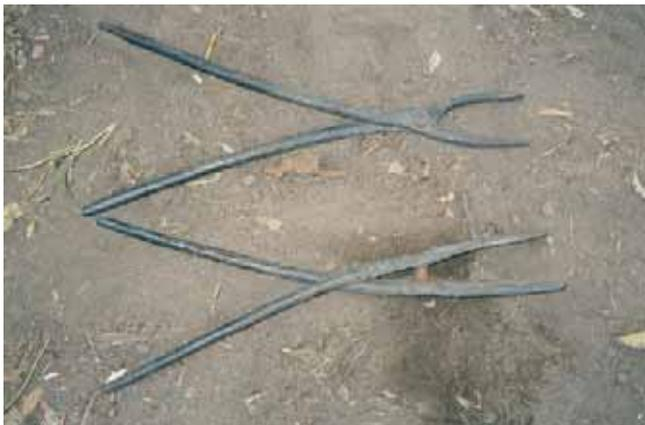
L'axe des pinces sénoufo traditionnelles est placé dans un plan perpendiculaire à celui qui caractérise le montage des pinces inspirées des modèles européens
