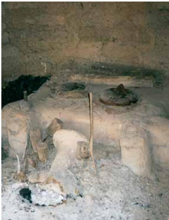
Le soufflet sénoufo traditionnel est constitué d'une impressionnante structure en pisé. Il est actionné à l'aide de deux membranes de cuir.
