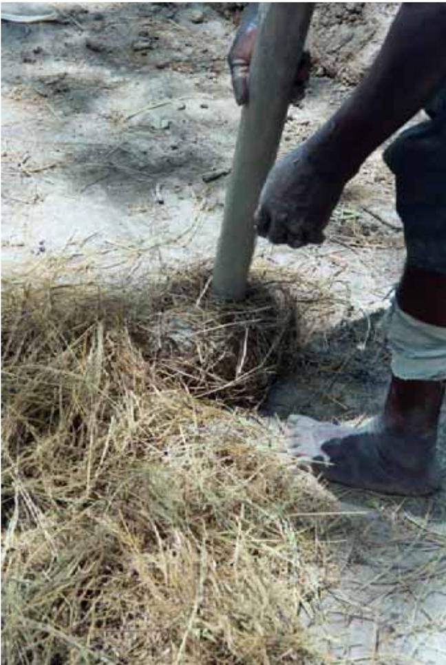
Introduction du moule dans la galette d'argile et étirement de l'argile sur le moule.
