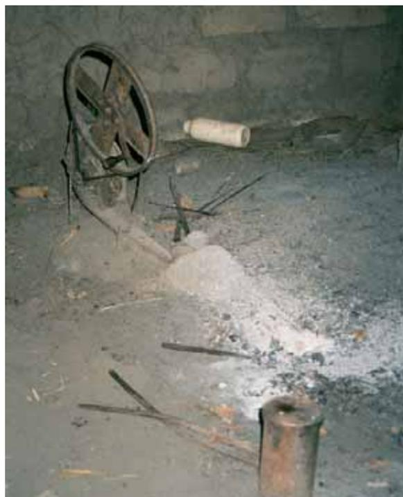
Les foyers des forges sont actuellement alimentés par un appareillage qui comprend une roue/poulie actionnée par le forgeron ou un apprenti et qui transmet sa rotation à une petite turbine par l'intermédiaire d'une courroie.
